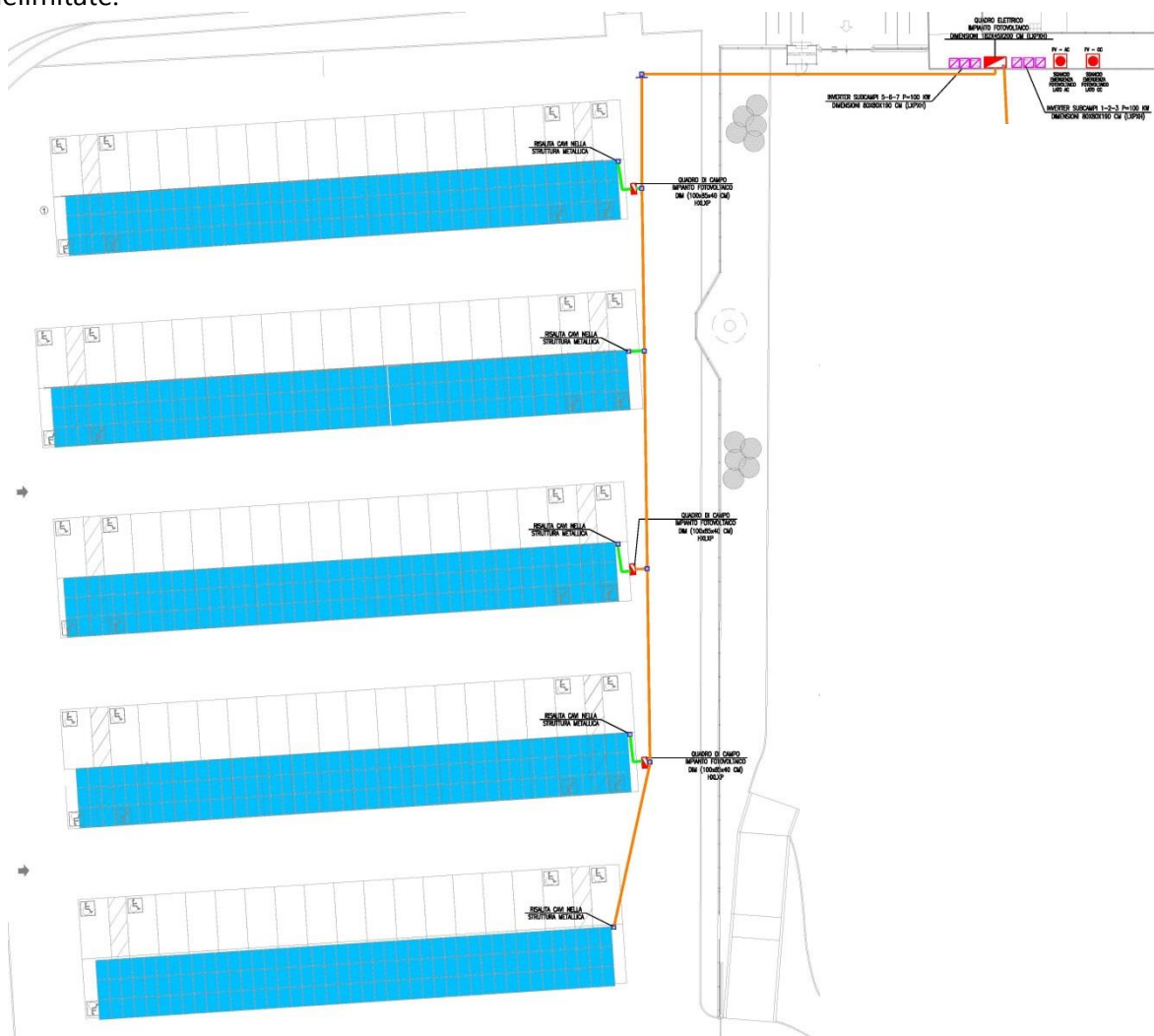
Figura 34. Progetto impianto fotovoltaico sulle pensiline.
